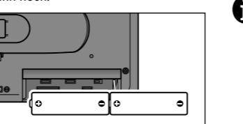
2. Legen Sie die beiden Batterien wie im Batteriefach abgebildet ein. Beachten Sie die korrekte Polarität (+/-).
