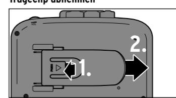
D Ziehen Sie die Lasche (PUSH) am Trageclip nach oben (1.) und ziehen Sie den Trageclip wie abgebildet zur Seite heraus (2.).
