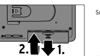
1. Schieben Sie den Batteriefachdeckel ein wenig nach unten und klappen ihn dann hoch.
