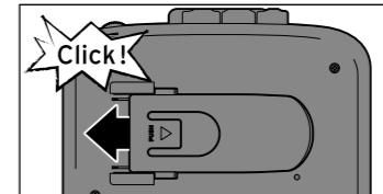
D Schieben Sie den Trageclip bis zum Anschlag in die Führungsschienen. Der Trageclip muss hörbar und spürbar einrasten.
